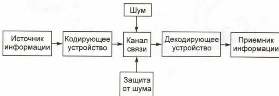
Рис. 1.3. Схема технической системы передачи информации
